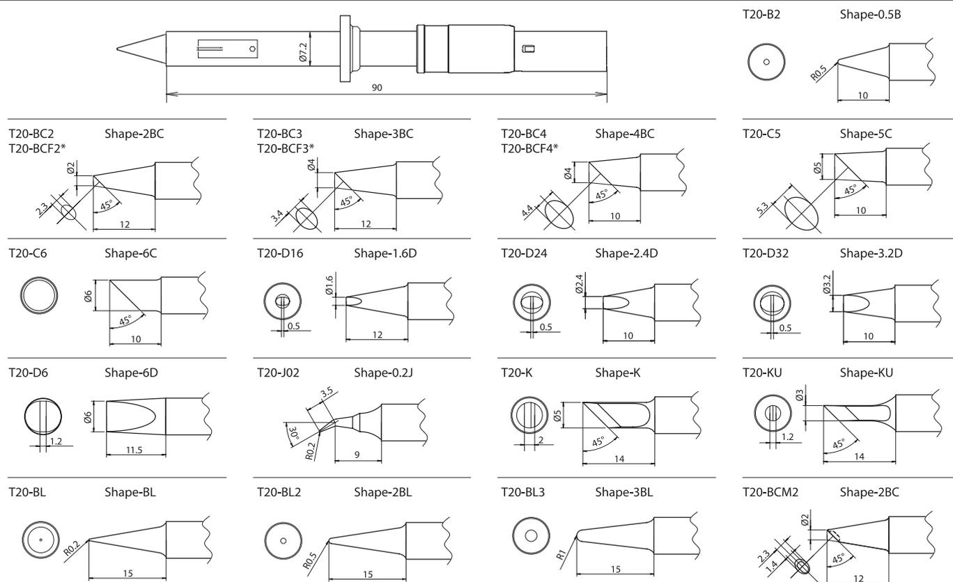
\* Отмеченные наконечники имеют покрытие только на паяльной поверхности
